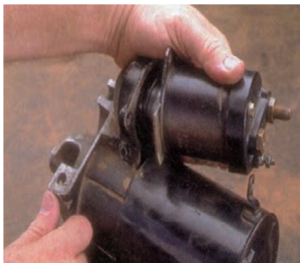
شکل ۸-۵۴ – خارج کردن اتومات
