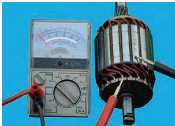
شکل ۸-۶۷ — آزمایش اتصال کوتاه شدن آرمیچر
