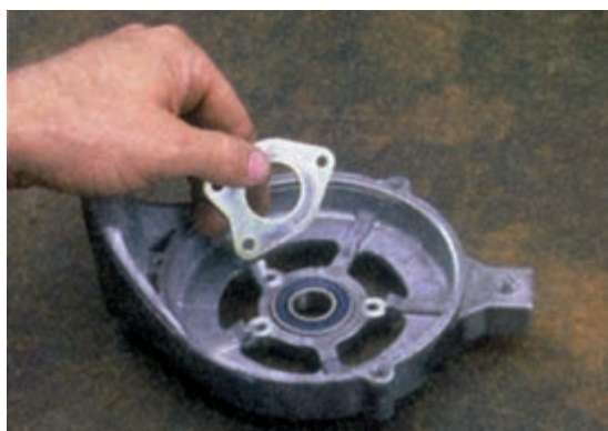
شکل ۶۸-۷ - در آوردن نگهدارنده‌ی بلبرینگ
