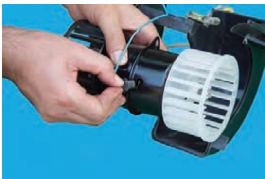
شکل ۴-۴۱- جدا کردن سیم از زغال‌ها
