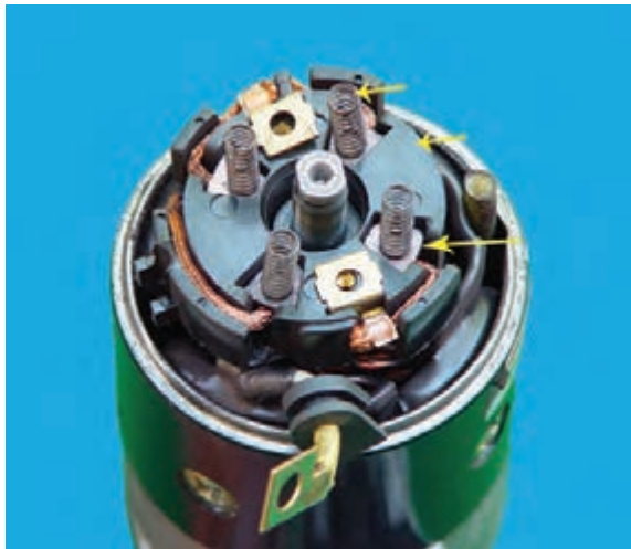
۱- فر زغال ۲- پایه‌ی نگه‌دارنده‌ی زغال ۳- زغال شکل ۲۳- ۸- مجموعه‌ی زغال‌ها و نگه‌دارنده‌ی آن‌ها
