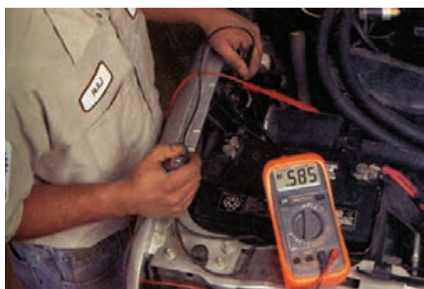
شکل ۸-۴۴ اندازه‌گیری افت ولتاژ پلاتین‌های سولونوید استارتر
