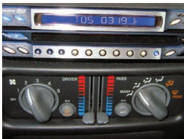
شکل ۵-۲۳ سوئیچ راه‌انداز فن کولر
