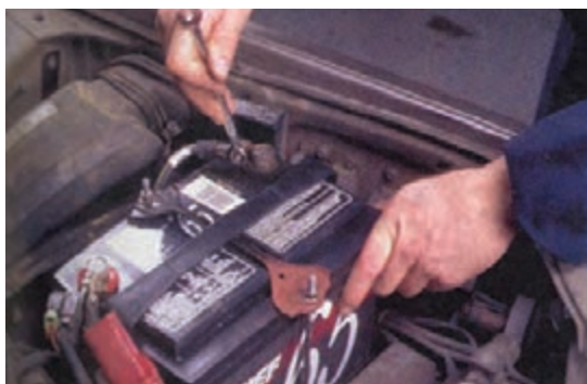
شکل ۱-۹۵- اتصال کابل‌های مثبت و منفی باتری
