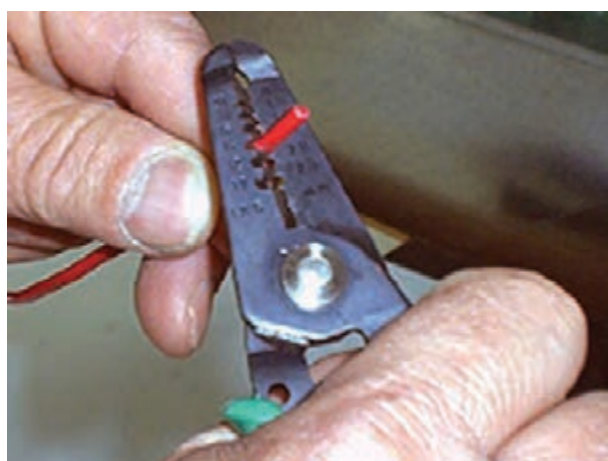
شکل ۳-۳۸- جدا کردن عایق سر سیم‌ها
