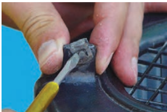
شکل ۴-۳۸ – باز کردن ضامن خار
