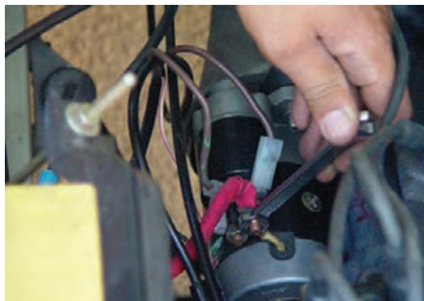
شکل ۸-۴۸ – جدا کردن اتصالات الکتریکی استارتر
