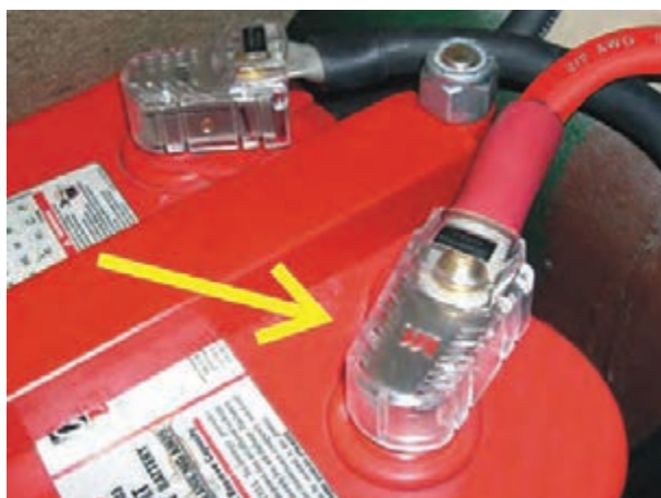
شکل ۱۹-۲- مورد استفاده تلق محافظ قطب‌های باتری
