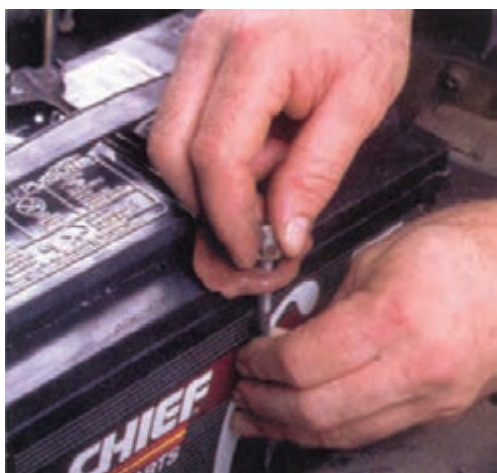
شکل ۹۴-۱- بستن باتری روی خودرو
