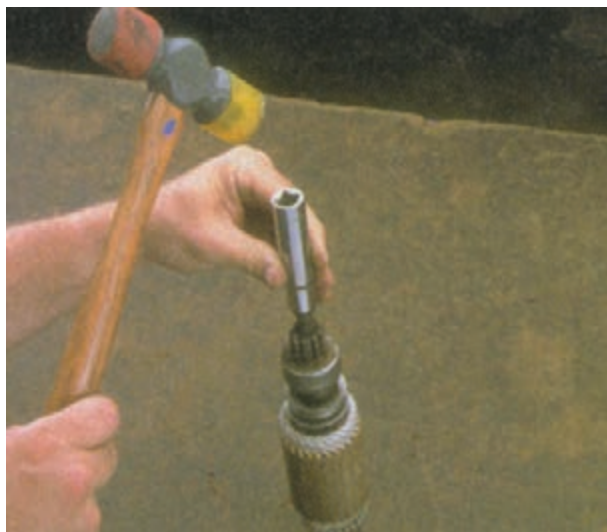
شکل ۸-۵۹ – ضربه زدن با چکش روی خار
