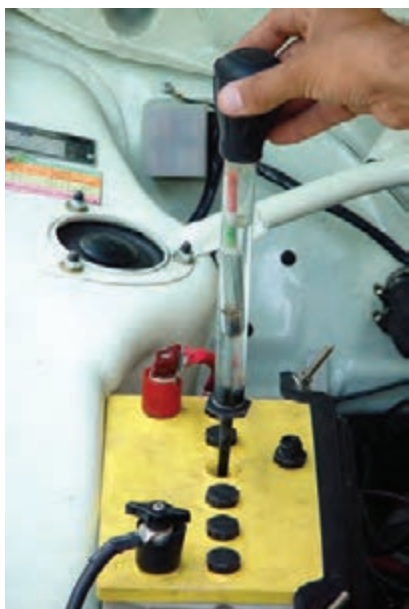
شکل ۸-۲۸- بررسی دشارژ باتری
