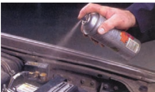
شکل ۱-۹۶- پاشیدن محلول ضدخوردگی روی بست
