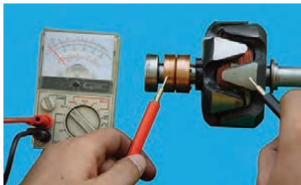
شکل ۷۴-۷ آزمایش اتصال بدنه نبودن سیم پیچ روتور
