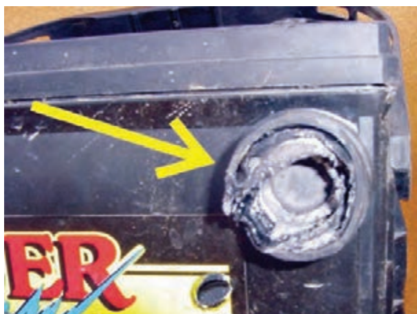
شکل ۳۶-۲ معیوب بودن ترمینال باتری
