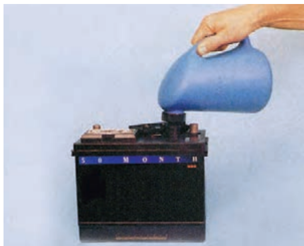
شکل ۲۷-۱- پر کردن خانه‌های باتری نو با الکترولیت
