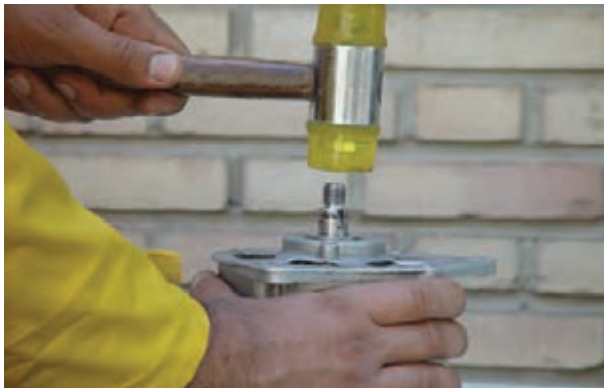
شکل ۶۳-۷ – بیرون آوردن روتور از درپوش
