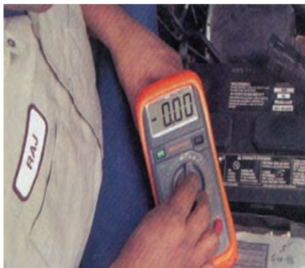
شکل ۸-۳۵ تنظیم مولتی متر روی شاخص ولتاژ
