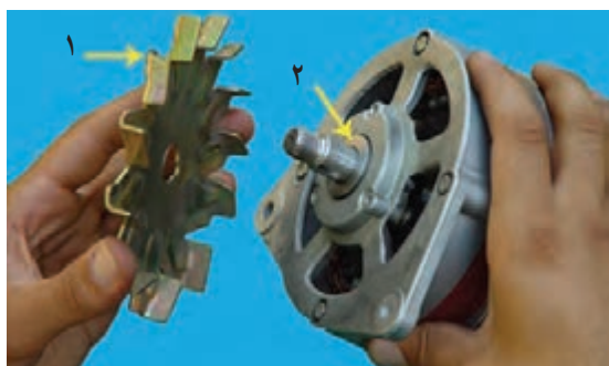
۱- پروانه ۲- واشر تکیه گاه پروانه شکل ۵۹- ۷- جدا کردن پروانه خنک کن
