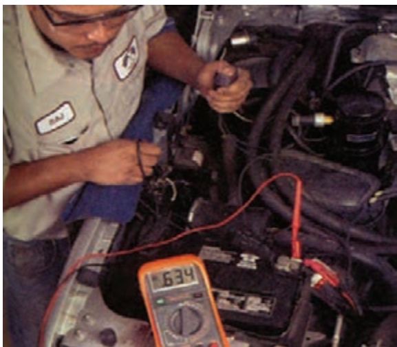
شکل ۸-۳۹- آزمایش افت ولتاژ باتری به خروجی رله
