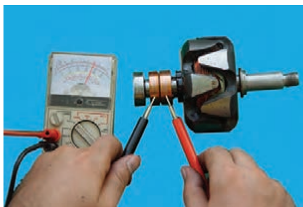
شکل ۷۵-۷ آزمایش سالم بودن سیم پیچ روتور
