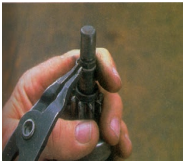
شکل ۸-۶۱ – درآوردن خار رینگ‌ی
