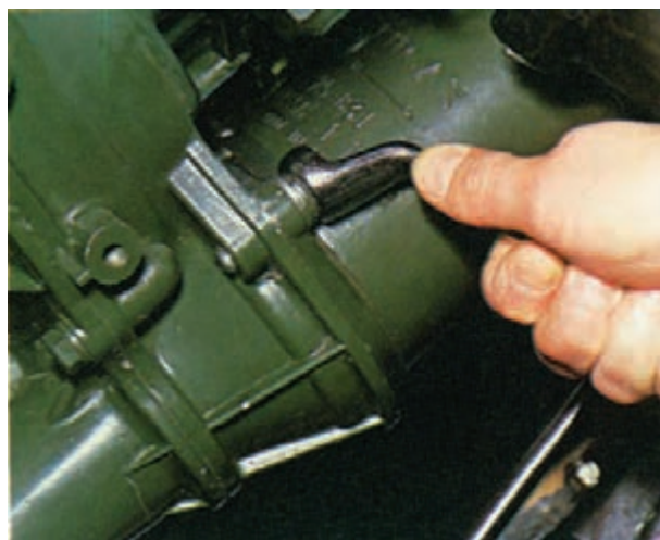
شکل ۸-۷۶ - بستن استارتر روی موتور
