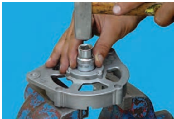
شکل ۶۹-۷ - بیرون آوردن بلبرینگ
