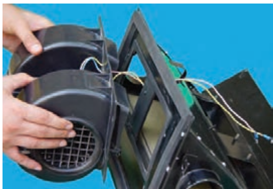
شکل ۴-۳۷ – جدا کردن محفظه‌ی موتور از بخاری
