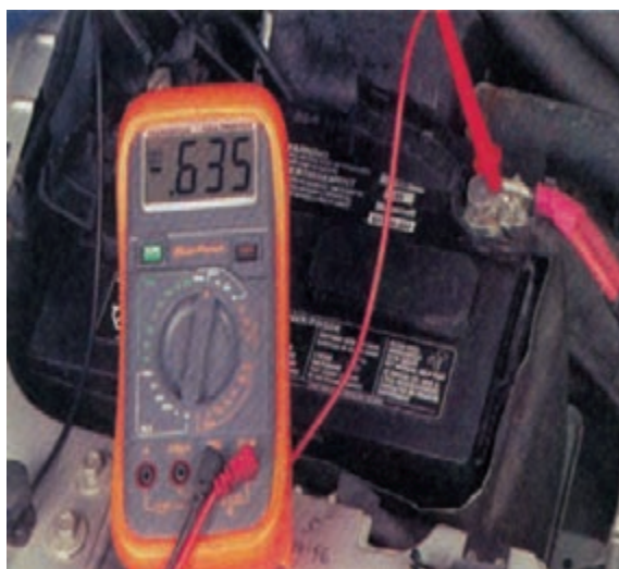
شکل ۸-۳۷ – اندازه‌گیری افت ولتاژ جریان ورودی کابل استارتر
