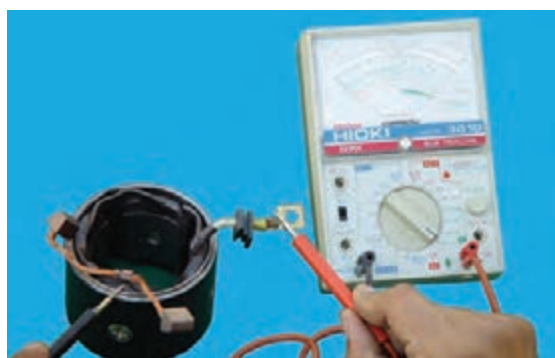
شکل ۸-۷۵ - آزمایش اتصال بدنه‌ی بالشتک
