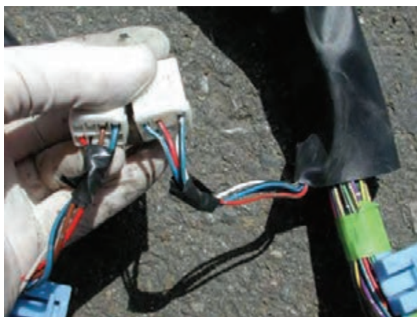
شکل ۳-۲۳- مقایسه و تطبیق سوکت‌های کلاف سیم‌کشی
