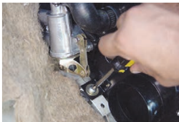
شکل ۴-۳۳- پیچ‌های پایه‌ی بخاری
