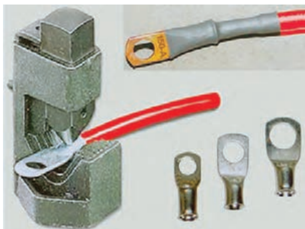
شکل ۸۰-۸- اتصال بست به کابل باتری
