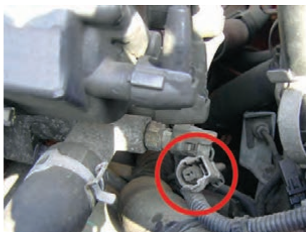
شکل ۱۶-۶ جدا کردن سوکت اتصال
