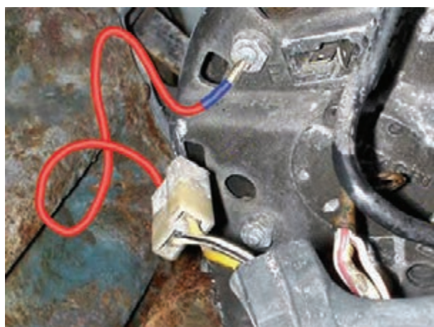
شکل ۳-۳۶ - آزمایش مدار لامپ شارژ
