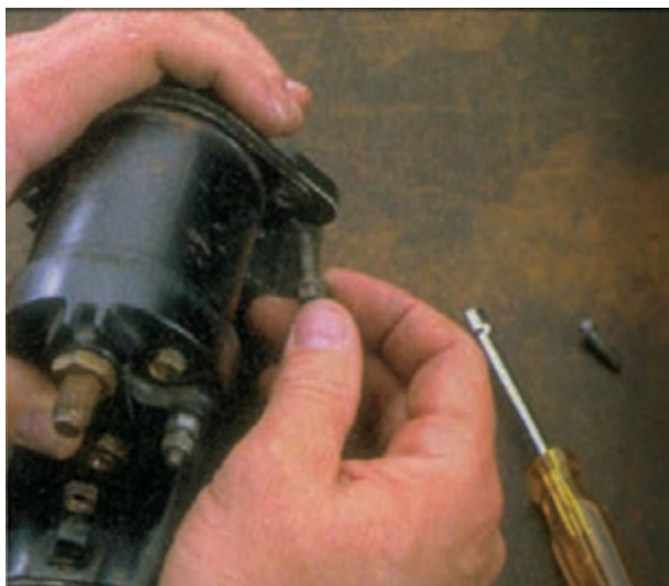
شکل ۸-۵۳ – بیرون آوردن پیچ‌های اتومات
