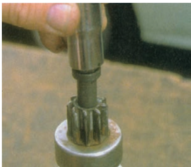
شکل ۸-۶۰ – خارج کردن حلقه رینگ‌ی از شیار شافت
