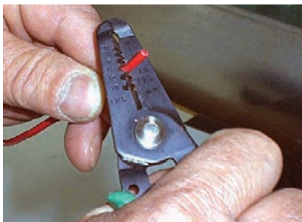
شکل ۴-۶۴- جدا کردن عایق سیم‌ها
