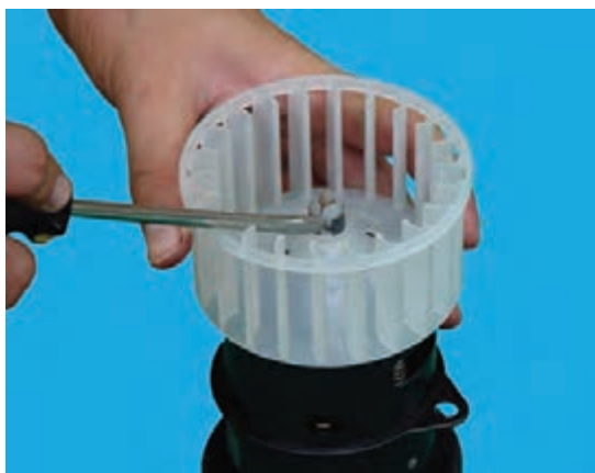
شکل ۴-۴۲- درآوردن خار نگهدارنده‌ی فن
