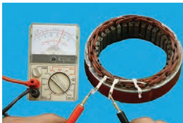
شکل ۷-۷۹ — آزمایش سالم بودن سیم پیچ استاتور
