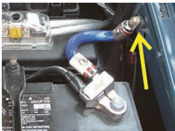
شکل ۲-۲۴ اتصال کابل منفی باتری به بدنه
