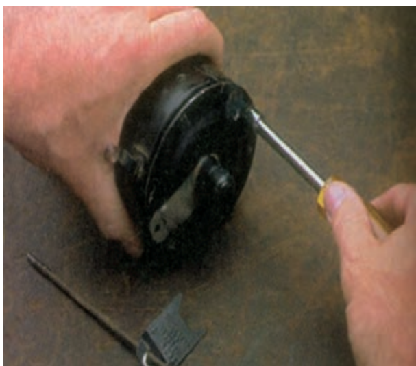
شکل ۸-۵۵ – باز کردن پیچ‌های اتصال درپوش به بدنه
