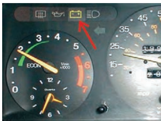
شکل ۱۰-۳ لامپ شارژ یک نوع خودرو
