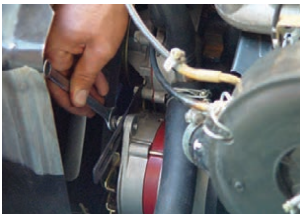
شکل ۷-۴۹ - باز کردن پیچ کشش تسمه پروانه
