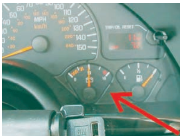
شکل ۹۰-۷ بررسی شارژ آلترناتور با نشان‌دهنده‌ی روی پانل جلوی راننده
