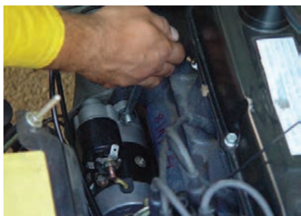
الف – باز کردن پیچ‌های استارتر
