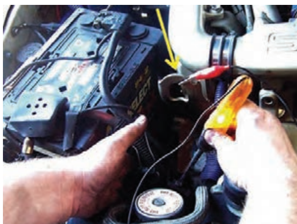
شکل ۴۳-۵ نحوه ی آزمایش سالم بودن سیم کشی
