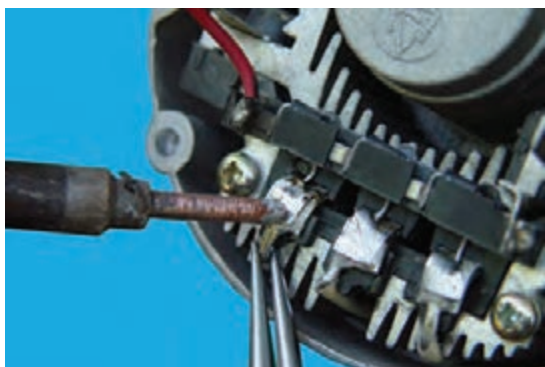
شکل ۷-۵۶- جدا کردن سیم‌های استاتور از یک‌سوکننده
