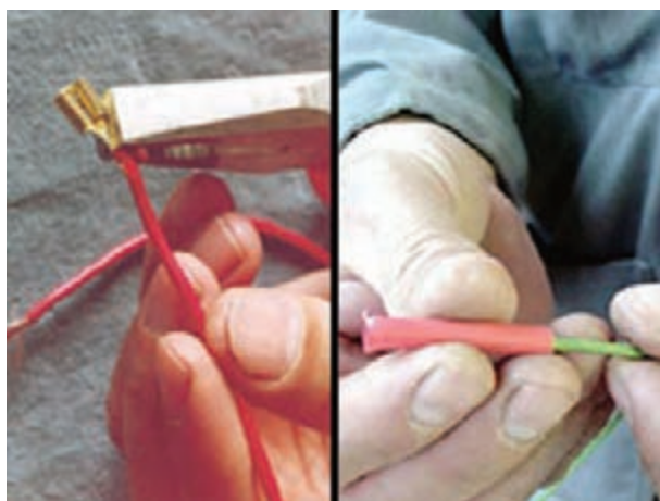
شکل ۴-۶۵- آماده کردن سیم‌ها
