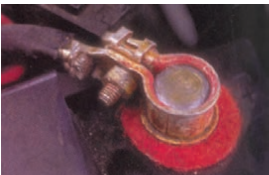
شکل ۱-۹۷- گریس زدن بست قطب‌ها
