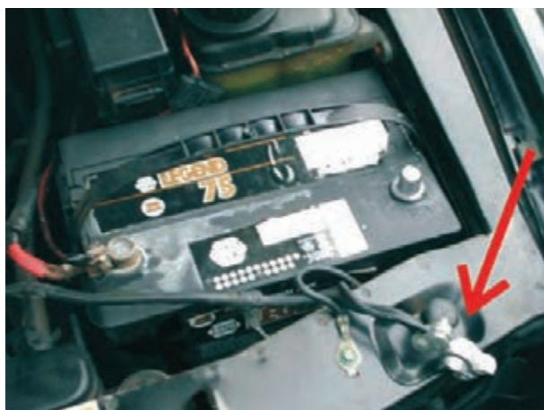
شکل ۱۵-۶ جدا کردن بست کابل اتصال بدنه‌ی باتری
