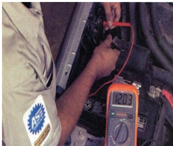
شکل ۸-۴۳ ولتاژ روی ولت‌متر
