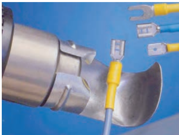
شکل ۷۹-۸- عایق کاری اتصال سرسیم به سیم
