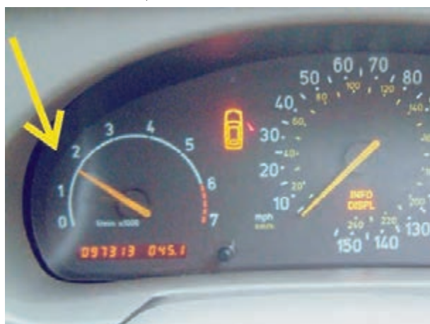
شکل ۷-۱۰۱- افزایش دور موتور برای آزمایش
