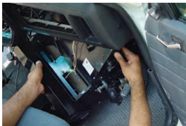
شکل ۴-۳۴- خارج کردن بخاری از محل نصب آب
