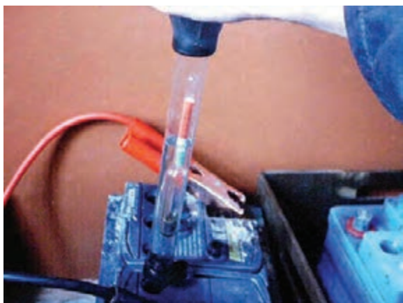
شکل ۱-۶۲- کنترل غلظت الکترولیت
