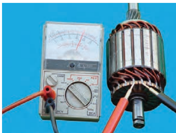
شکل ۸-۶۶ — آزمایش سیم پیچ‌های آرمیچر — سالم بودن سیم‌ها و اتصال به لامل‌ها
