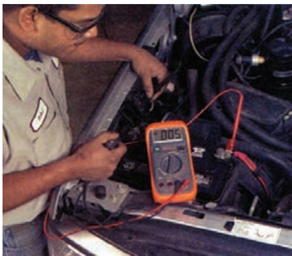
شکل ۸-۴۰- اتصال سیم منفی ولت‌متر به ورودی رله
