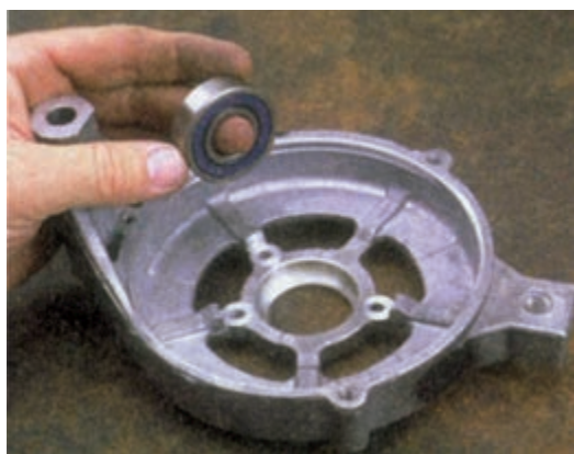
شکل ۷۰-۷ - خارج کردن بلبرینگ و آزمایش آن
