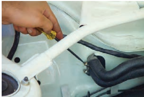
شکل ۴-۳۱- باز کردن لوله‌های آب رادیاتور بخاری
