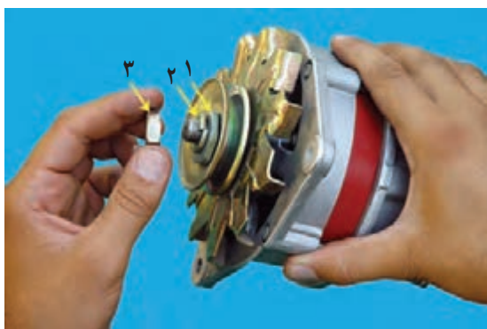
۱- واشر شش گوش ۲- واشر فتری ۳- مهره شکل ۵۷- ۷- باز کردن مهره ی پولی
