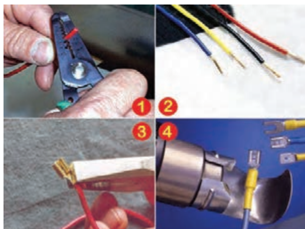
شکل ۴۷-۵- آماده کردن سیم‌ها برای سیم‌کشی
