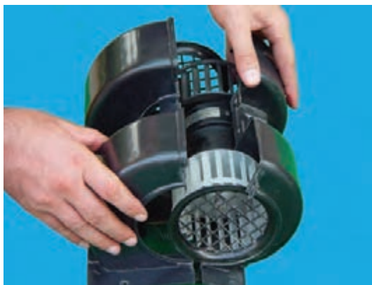
شکل ۴-۴۰ – جدا کردن محفظه‌ی نگه‌دارنده‌ی موتور
