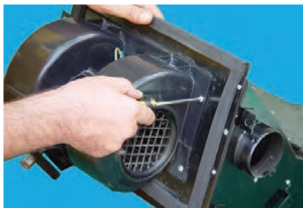
شکل ۴-۳۶- باز کردن پیچ‌های محفظه‌ی موتور
