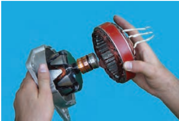
شکل ۶۲-۷ – جدا کردن استاتور
