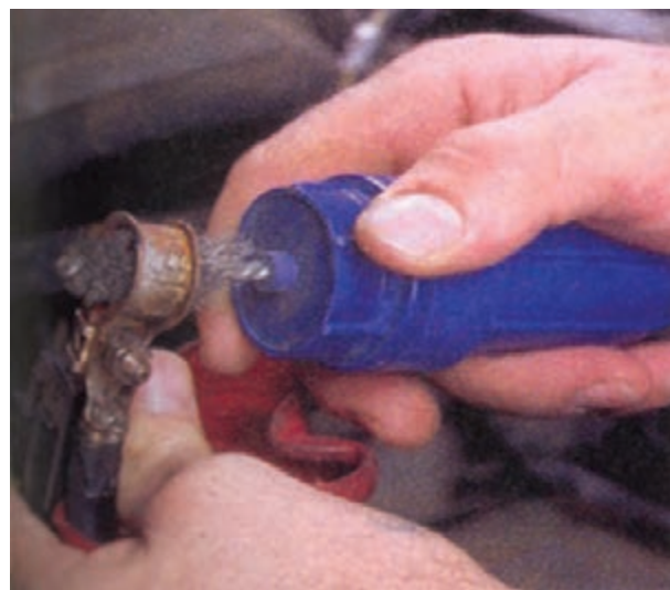
شکل ۹۱-۱ - پاک کردن بست‌های باتری با برس سیمی
