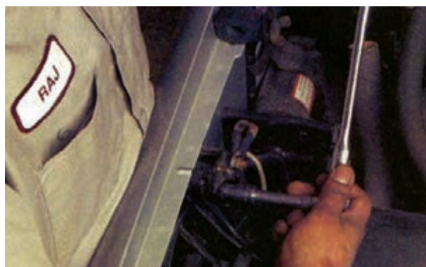
شکل ۸-۴۵ - اندازه‌گیری افت ولتاژ رله‌ی استارتر
