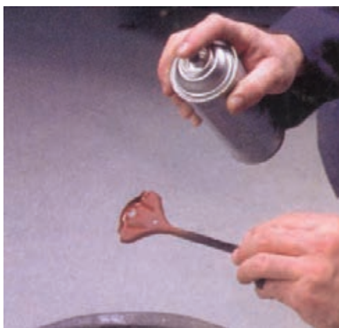
شکل ۹۳-۱- اسپری ضدخوردگی روی بست نگه‌دارنده‌ی باتری
