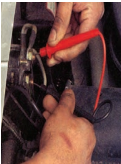
شکل ۸-۴۲ اتصال فیض‌های ولت‌متر به اتومات استارتر
