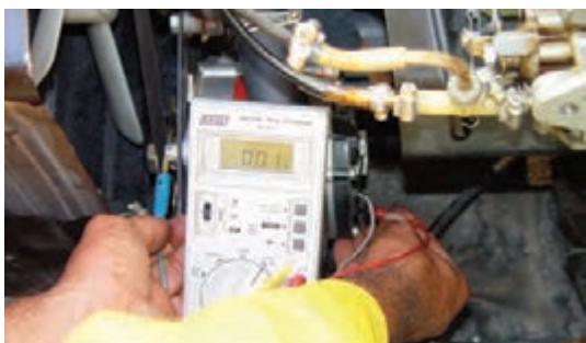
شکل ۷۲-۷۱ - اتصال ولت‌متر بین ترمینال B و بدنه
