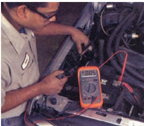
شکل ۸-۴۱- اندازه‌گیری افت ولتاژ کابل متصل به رله
