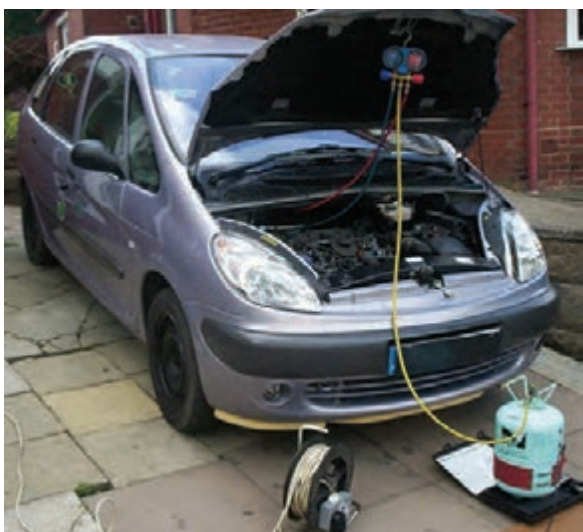
شکل ۳۵-۵ شارژ گاز کولر
