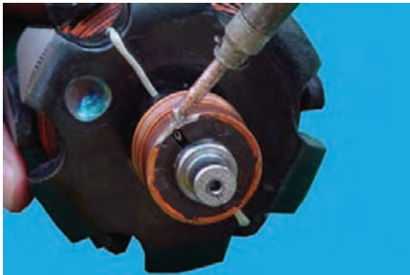
شکل ۶۶-۷ – جدا کردن سیم های روتور از کلکتور
