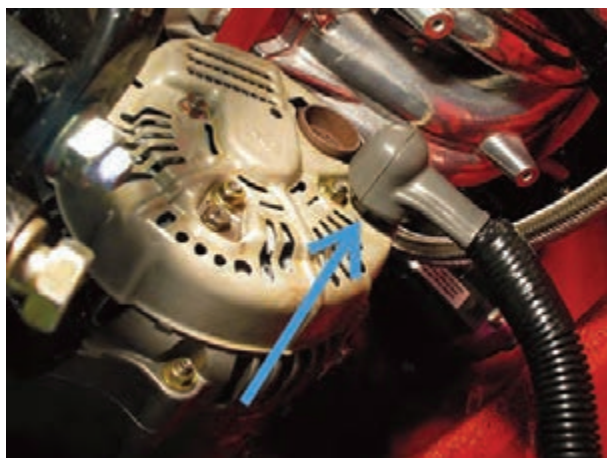
شکل ۳-۲۴- عایق اتصال الکتریکی ترمینال آلترناتور
