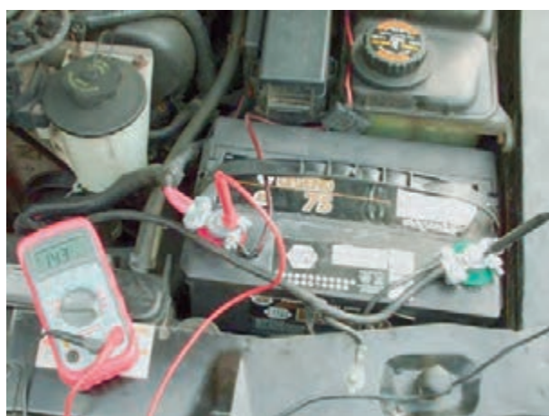
شکل ۷-۱۰۲- اندازه‌گیری ولتاژ شارژ
