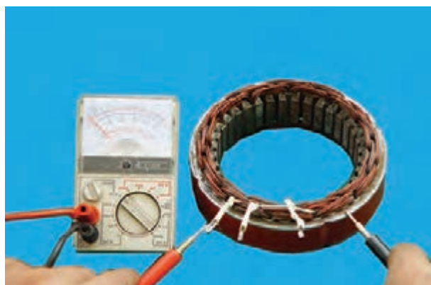
شکل ۷-۷۸ — آزمایش اتصال بدنه نبودن سیم پیچ استاتور
