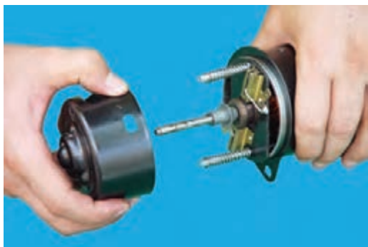
شکل ۴۵-۴ جدا کردن پوسته‌ی موتور
