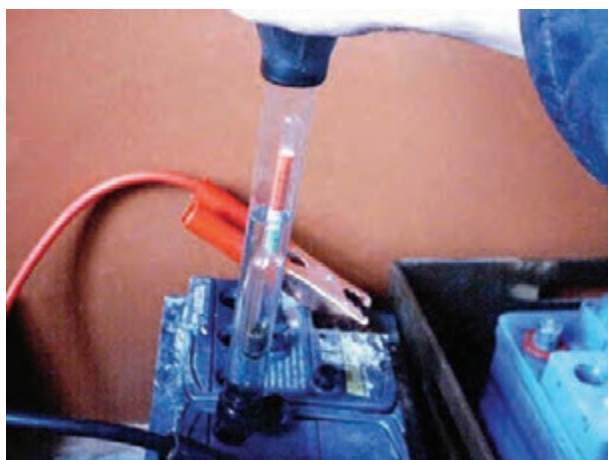
شکل ۵۳-۱ کنترل غلظت الکترولیت
