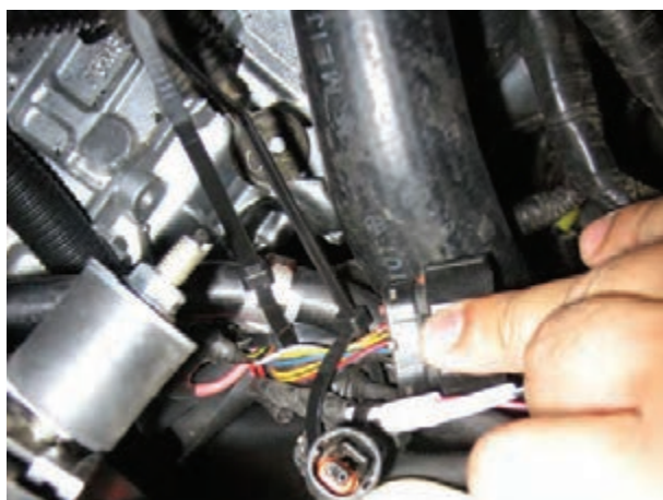
شکل ۴۵-۵ بررسی اتصالات الکتریکی سیم‌کشی
