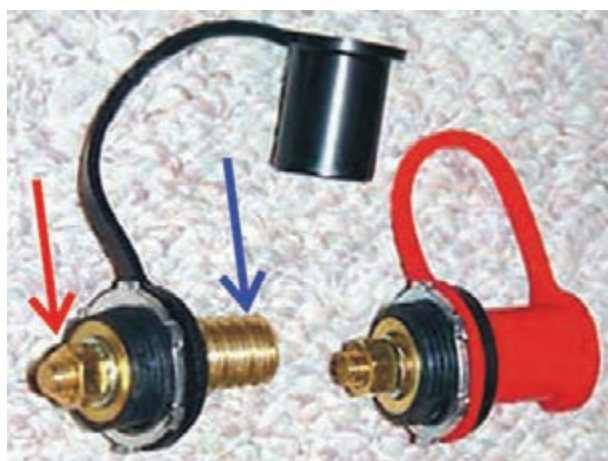
شکل ۱۴-۲- واسطه‌ی اتصال ترمینال باتری
