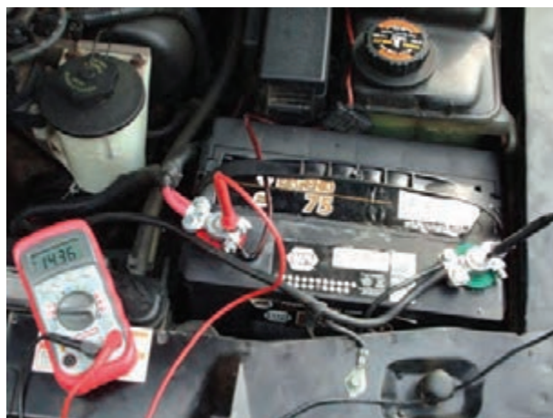
شکل ۱-۶۶ — اندازه گیری ولتاژ باتری
