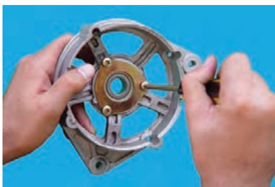
شکل ۶۷-۷ - باز کردن پیچ‌های نگهدارنده‌ی بلبرینگ
