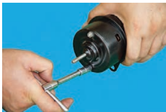
شکل ۴-۴۴- باز کردن پیچ‌های پوسته‌ی موتور
