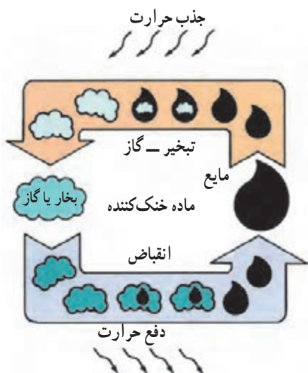
شکل ۵-۳ مراحل تغییر ماده خنک کننده
