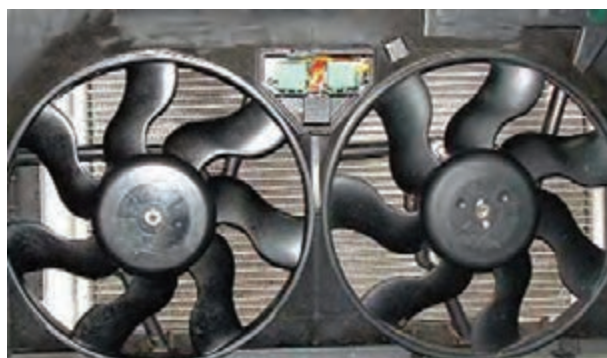
شکل ۱۴-۵- فن‌های نصب شده در روی رادیاتور یک نوع خودرو
