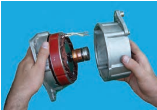
شکل ۶۱-۷ – جدا کردن درپوش‌های آلترناتور
