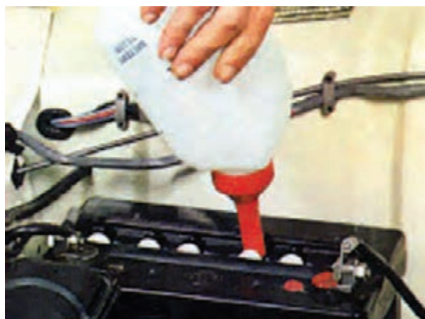
شکل ۱-۷۴- کنترل سطح الکترولیت
