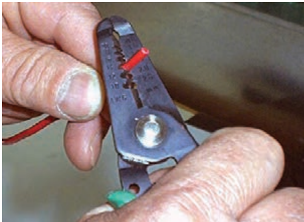
شکل ۶-۳۰ جدا کردن عایق سیم
