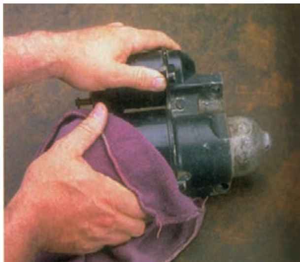
شکل ۸-۵۰ - تمیز کردن استارتر
